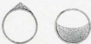
Fig. 53. — Tube d'eau. Fig. 54. — Tube de fumée.
