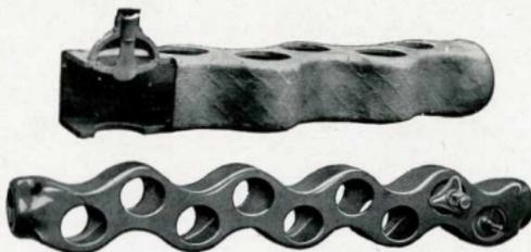
Fig. 36 et 37. — Collecteurs ondulés en acier forgé et embouti.
